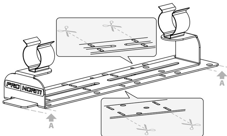
3. Visser les vis et écrous freins sur la rainure centrale pour assembler les deux parties du support et verrouiller la longueur désirée.
